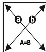
ЗАМЕРЬТЕ ДИАГОНАЛИ СОБРАННОГО КАРКАСА, ОНИ ДОЛЖНЫ БЫТЬ РАВНЫМИ (+/- 1,2мм) (ТОЛЬКО ПОСЛЕ ЭТОГО МОЖЕТЕ ЗАКРЕПИТЬ ЗАДНЮЮ СТЕНКУ ИЗ ЛДВП ПРИ ПОМОЩИ ГВОЗДЕЙ)
