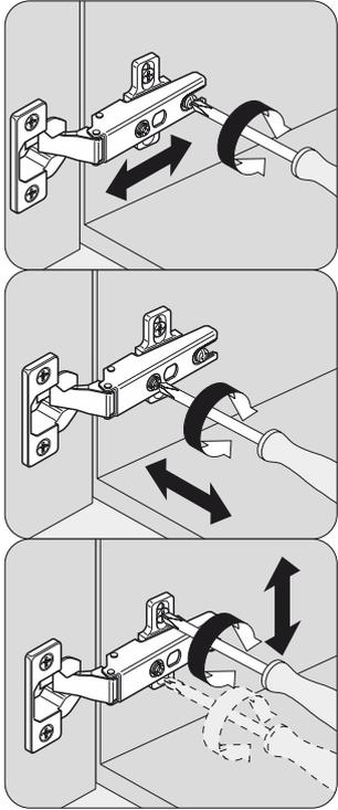
Схема регулировки петель
