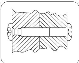
При наличии рядом стоящего изделия необходимо стянуть их между собой с помощью межсекционной стяжки, предварительно просверлив сквозные отверстия-Ø5.
