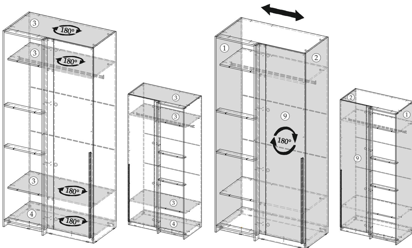
Детали № 2, 3, 4, 9, 10, 11 с симметричной сверловкой, поэтому в зависимости от стороны сборки их можно переворачивать на 180 град.
