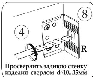
Просверлить заднюю стенку изделия сверлом d=10...15мм
