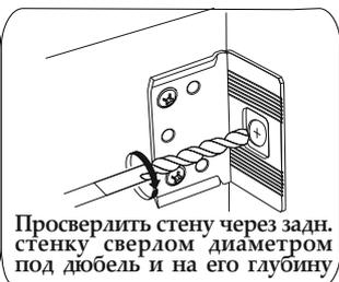
Просверлить стену через задн. стенку сверлом диаметром под дюбель и на его глубину
