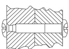
При наличии рядом стоящего изделия необходимо стянуть их между собой с помощью межсекционной стяжки, предварительно просверлив сквозные отверстия-Ø5.
