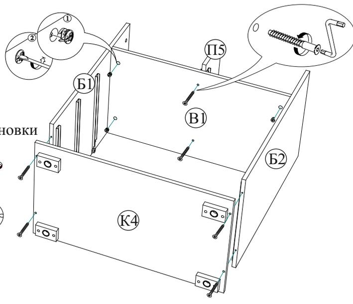
Рис.4 Схема прикручивания опор
