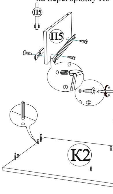
Рис.3 Схема расстановки шкантов и эксцентриковых стяжек
