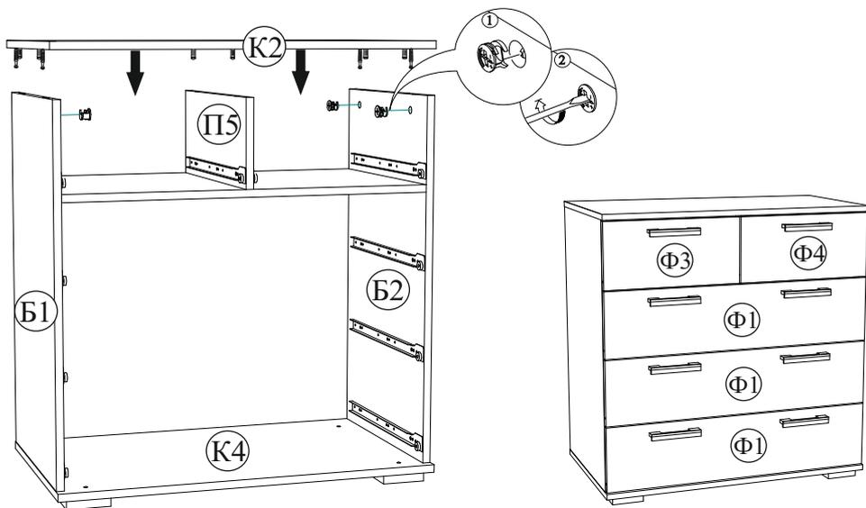
**Рис.9** Порядок сборки выдвижного ящика
