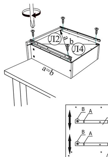
**Регулировка направляющих по высоте:** отверстие в точке А позволяет подогнать направляющую по высоте. Затем необходимо закрепить положение направляющей в точке В, при помощи шурупа 3x16.
