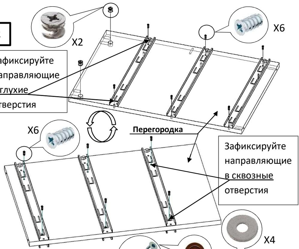
Зафиксируйте направляющие в сквозные отверстия
