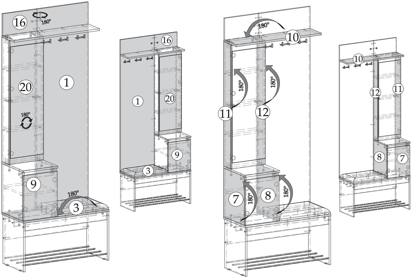
Детали № 1, 3, 7, 8, 9, 10, 11, 12, 16, 20 с универсальной сверловкой, поэтому в зависимости от стороны сборки их можно переворачивать на 180 град.
