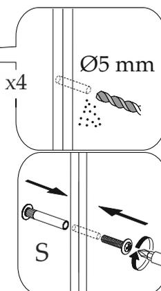
После установки модулей следует выровнять и скрепить их между собой межсекционной стяжкой, это придаст дополнительную жесткость всей конструкции.
