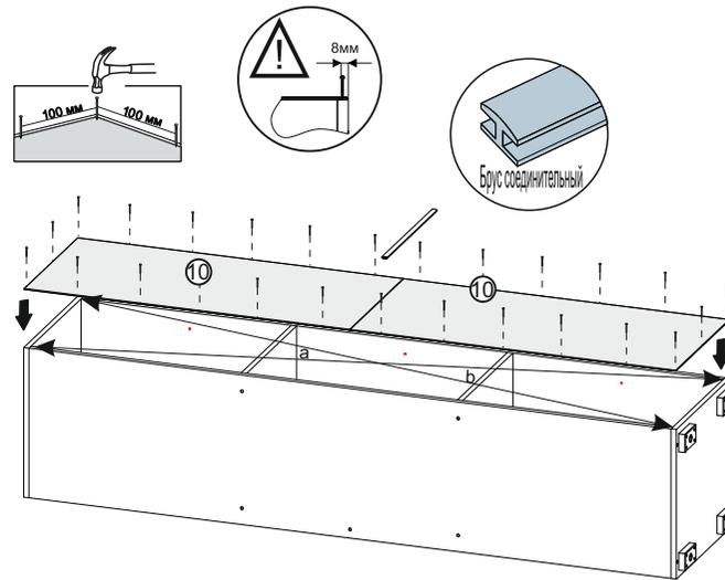
**ВАЖНО!!!** Замерьте диагонали собранного каркаса. Они должны быть равными (+/-1,2мм). Только после этого можете закрепить заднюю стенку ЛДВП при помощи гвоздей!
