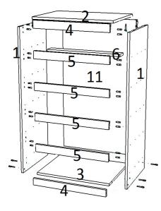
К детали 1 гвоздями прибить опоры. Шурупами 3,5\*16 привернуть направляющие колесом вперед и в готовые отверстия вставить шканты. Еврошурупами скрепить детали 1, 3, 4 и 6, при этом устанавливая планки 4 и 5 как показано на рисунке. В готовые отверстия детали 2 ввернуть эксцентрики и закрепить крышку замками с деталями 1.
