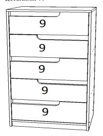
Шурупами 3,5\*16 привернуть направляющие к нижней части детали 7 колесом назад. Вкатить ящики в корпус комода.
