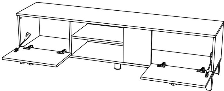
Схема установки барного кронштейна
