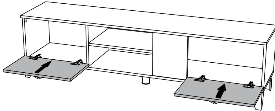
Установка и регулировка петель
