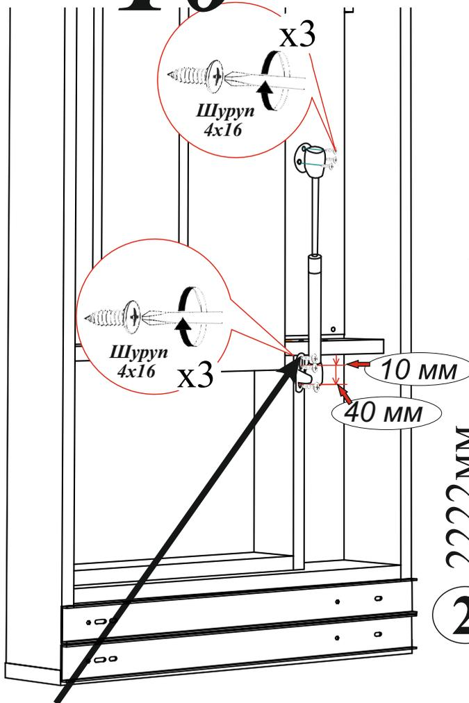
Вкрутить дополнительный шуруп 4x16 в верхнее положение для фиксации!!!
