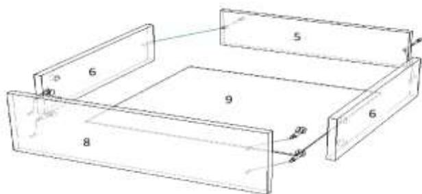
Еврошурупами скрутить детали 5 и 6, в пропил установить лдвп. В готовые отверстия в фасаде 8 ввернуть эксцентрик и закрепить фасад на корпусе ящика
