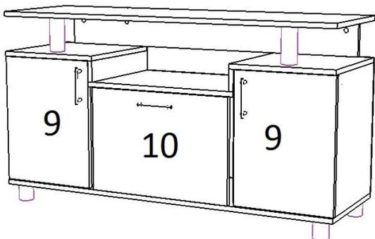
Шурупами 3,5\*16 привернуть петли к фасадам ( внутренние к фасаду 10, накладные к фасаду 9. Привернуть фасады к корпусу согласно рисунка и отрегулировать их. В готовые отверстия установить ручки. К фасаду 10 установить барный крашфейн.
