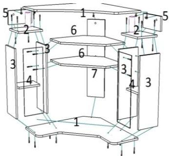
Деталь 3,7 еврошурупами скрепить с деталью 1/низ/ и вязками 6. Крышку 2 привернуть еврошурупами к планке 5 и боковинам 3. В крышку 1 вернуть эксцентрик и стянуть замками с деталями 7 и 5 предварительно установив джокерные трубы с флянцами.
