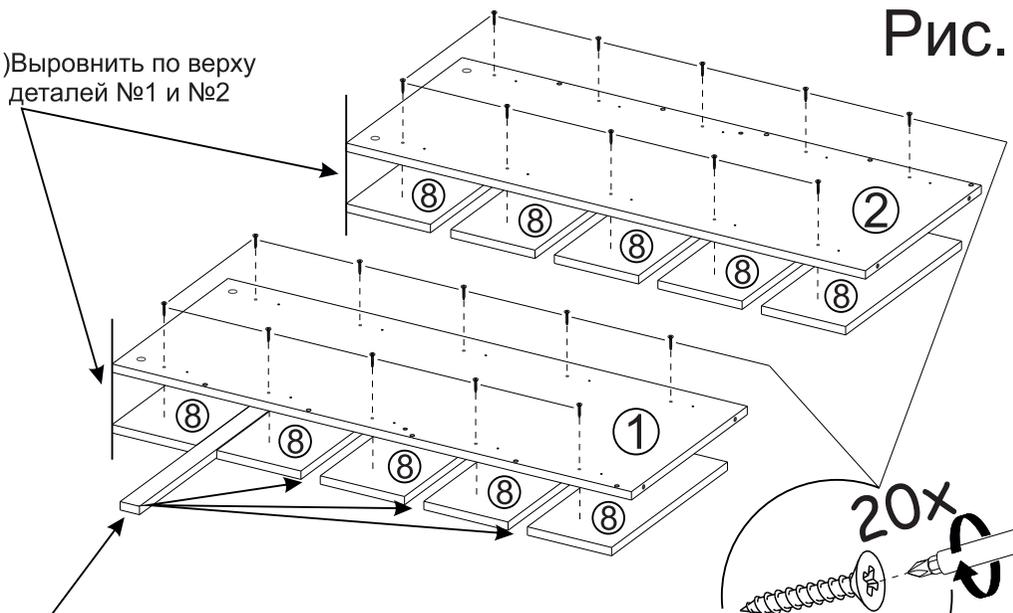
2) Для правильной установки деталей №8 использовать деталь №5 в роли шаблона
