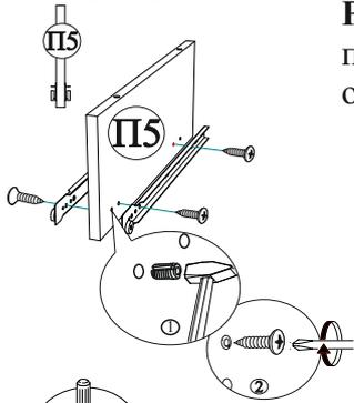
Рис.3 Схема прикручивания опор
