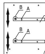
**Регулировка направляющих по высоте:** отверстие в точке А позволяет подогнать направляющую по высоте. Затем необходимо закрепить положение направляющей в точке В, при помощи шурупа 3x16.
