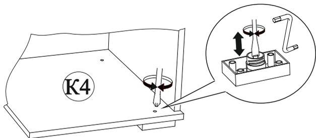
**Рис.9** Схема прибивки ЛДВП
