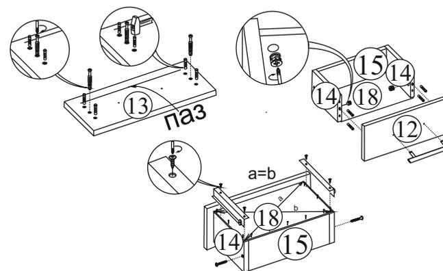
Рис.5 - Порядок сборки выдвижного ящика
