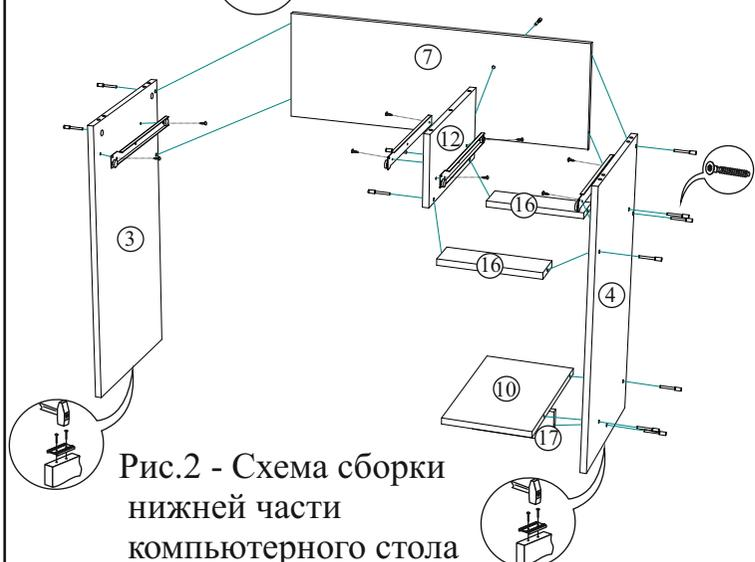
Рис.2 - Схема сборки нижней части компьютерного стола
