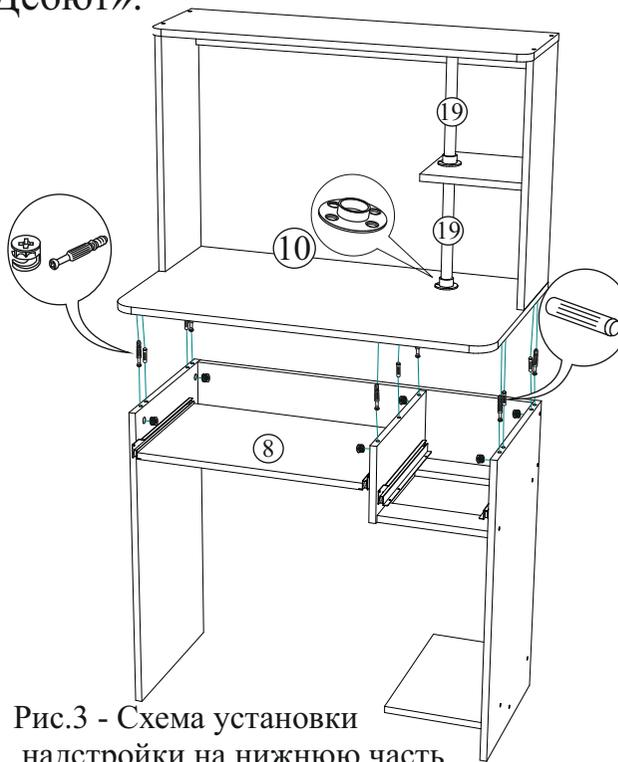
Рис.3 - Схема установки надстройки на нижнюю часть компьютерного стола
