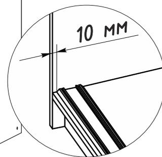
Нижняя направляющая устанавливается с зазором 10 мм от нижней крышки
